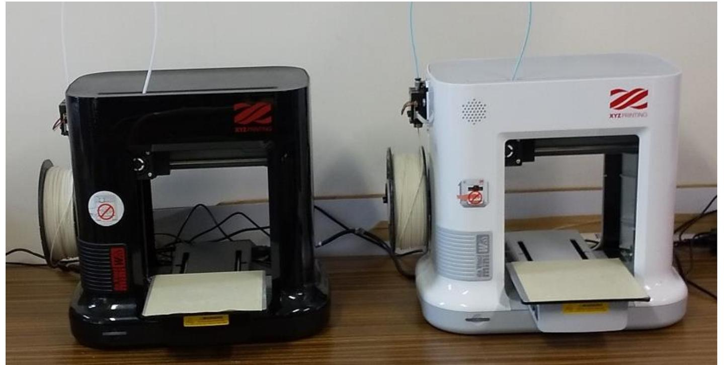
フィラメントを溶かしながら一層ずつ重ねて造形する、熱溶解積層方式(FDM)の3Dプリンタです
